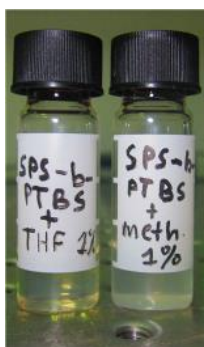
Σχήμα 1: Το συμπολυμερές SPS-b-PtBS σε διαλύτη μεθανόλη και σε διαλύτη THF 50/50 v/v, σε συγκέντρωση 1%.
