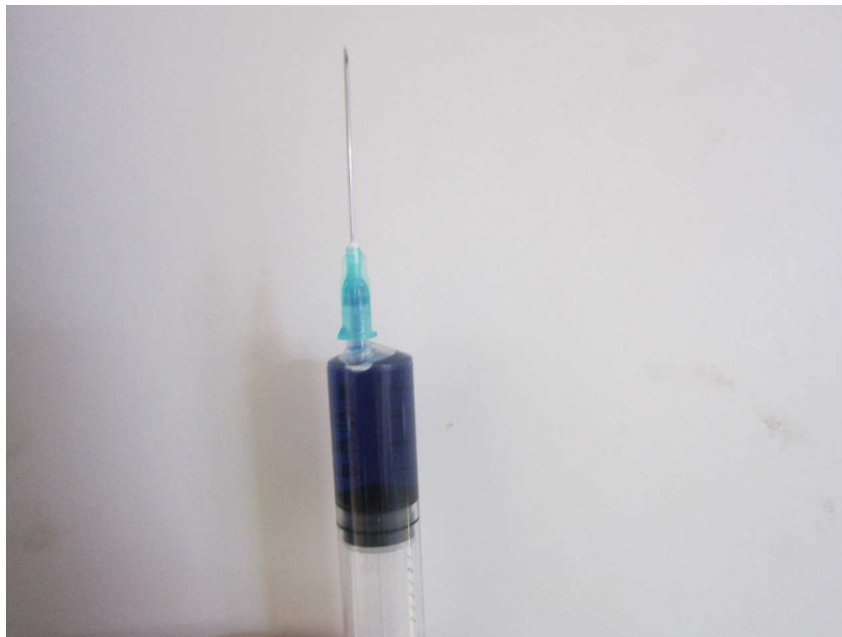
Σχήμα 4.12. Δείγμα χρωματισμένου (μπλε) υγρού πόρων με πυριτία μετά τη δειγματοληψία και εντός της φαρμακευτικής σύριγγας.
