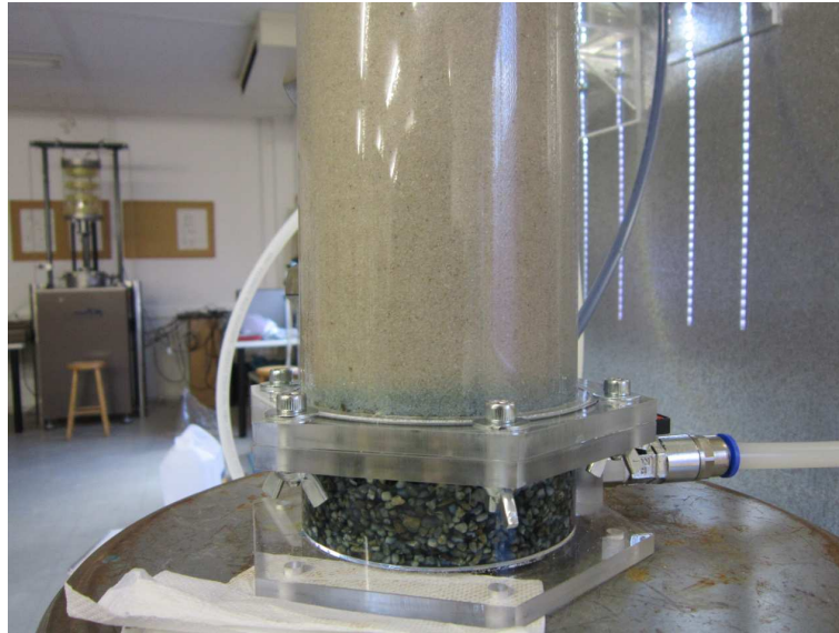
Σχήμα 4.7. Θέση μετώπου κολλοειδούς πυριτίας (με μπλέ χρώμα) μέσα σε μικρό δοκίμιο άμμου. Η πυριτία έχει εμβαπτίσει πλήρως το χοδρόκοκκο υλικό και εισέρχεται στο αμμώδες.
