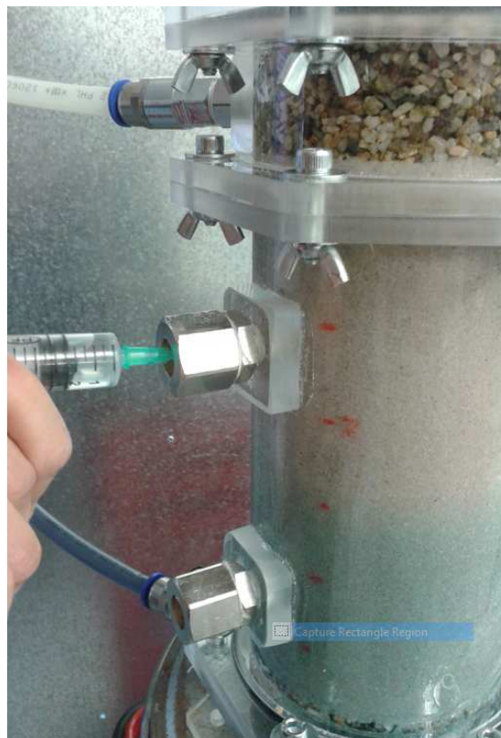
Σχήμα 4.8. Θέση μετώπου κολλοειδούς πυριτίας (με μπλέ χρώμα) στο μέσο ύψος εντός μικρού δοκιμίου άμμου. Φαίνεται η σκούρα μπλέ είσοδος της πυριτίας στο σωλήνα στο κάτω μέρος του δοκιμίου, και η διαδικασία δειγματοληψίας υγρού πόρων από θέση μπροστά (άνω) από το μέτωπο της πυριτίας εντός του δοκιμίου
